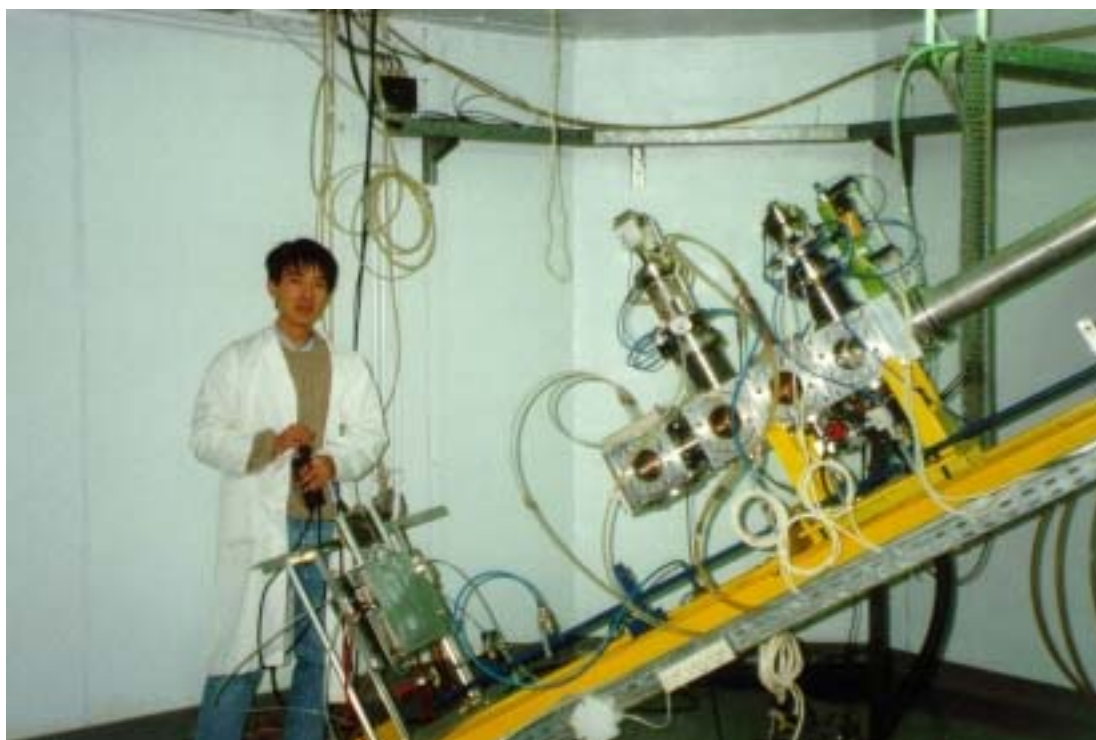
Figure 3.1 : Photographie de la nouvelle ligne de faisceau intense de neutrons rapides (voie T2).
