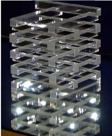
CMS a choisi un calorimètre électromagnétique composé de 80000 cristaux de verre au plomb ( $\text{PbWO}_4$ ).
